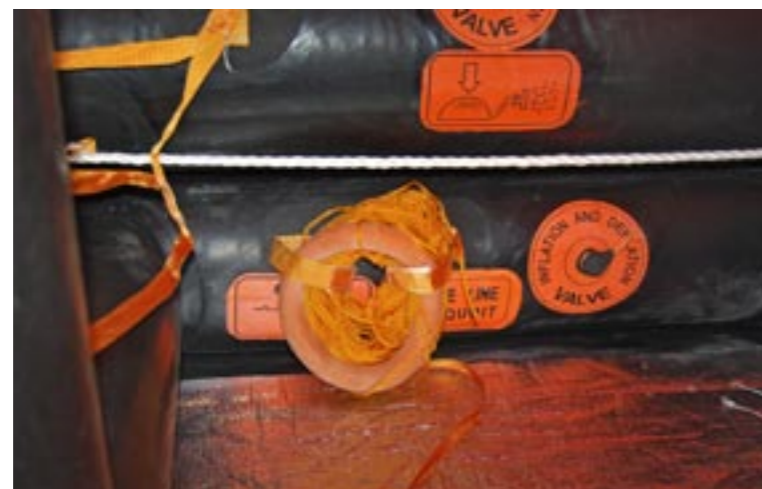
Kastringen kan användas till att hjälpa någon som simmar bredvid flotten och har svårt att ta sig fram. Den kan också användas till att kasta till en hjälpande båt som ligger inom kastavstånd.
